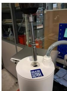
2. Introduire la douille de 5mm et chercher la vis d'entraînement
