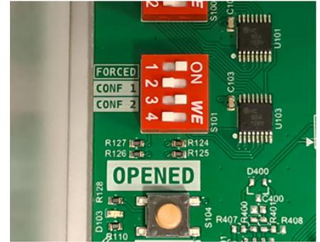
3. Mettre UNIBOX en mode FORCED en activant le dip-switch
