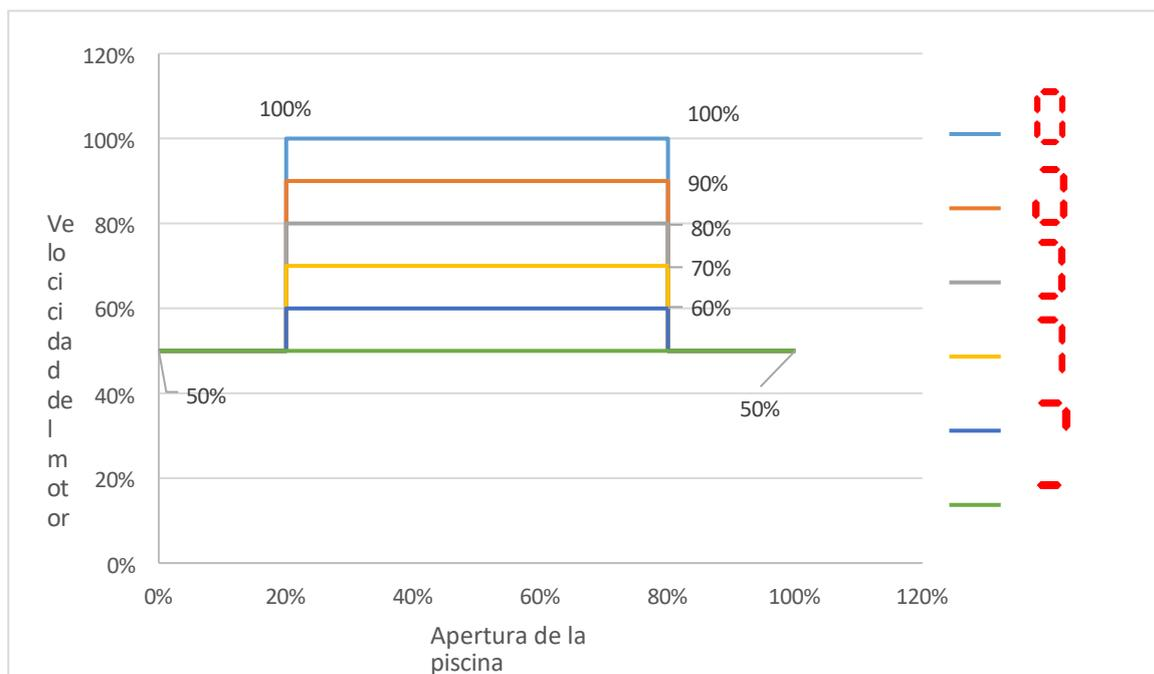
La parte izquierda del gráfico representa la rampa de salida, el centro del gráfico representa el rango de acción de la opción de control de la velocidad de cierre, y la parte derecha del gráfico representa el muelle suave.
