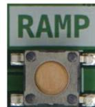
NOTE : Ne pas utiliser la rampe de vitesse sur les moteurs PL et DL7710 car leur vitesse nominale est déjà suffisamment lente (environ 2 rpm).
